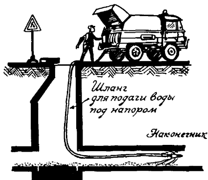
Устранение засорения путем размыва
